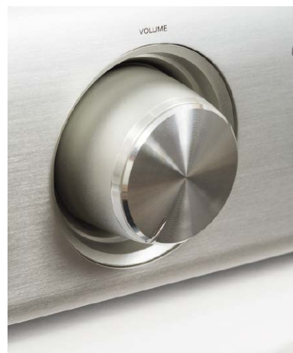
Cyfrowym pokusom nie poddała się regulacja głośności – tutaj z analogowym potencjometrem.
