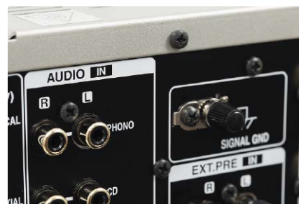
Wejście gramofonowe PMA-1700NE pozwala obsługiwać wkładki MM i MC.
